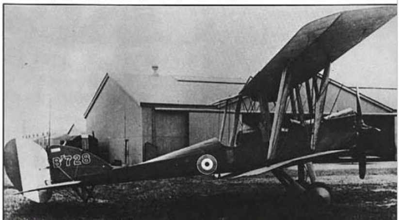
le BE.2e, développé du BE.2c, était un vieil appareil de reconnaissance encore opérationnel sur le front britannique. Son moteur de 90 ch lui conférait une vitesse de 120 km/h : un gibier de choix pour les chasseurs de Richthofen, qui volaient à 160 km/h
