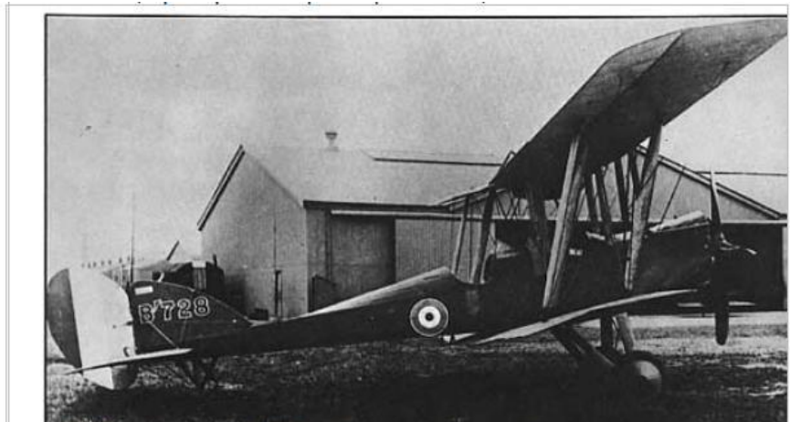
le BE.2e, développé du BE.2c, était un vieil appareil de reconnaissance encore opérationnel sur le front britannique. Son moteur de 90 ch lui conférait une vitesse de 120 km/h : un gibier de choix pour les chasseurs de Richthofen, qui volaient à 160 km/h
