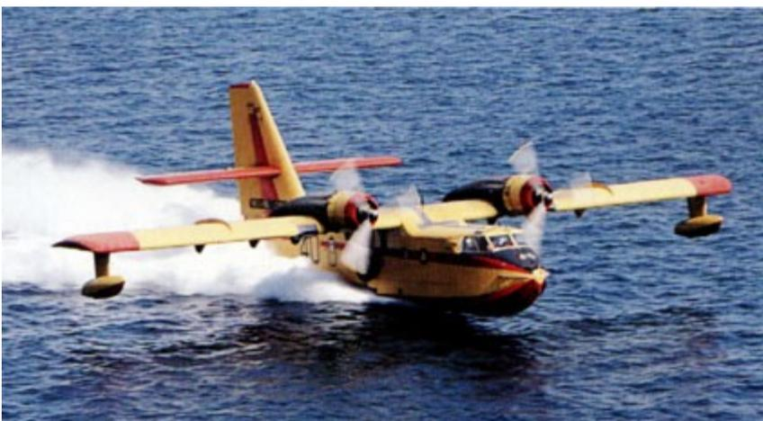
L'écopage peut se définir comme une séquence d'hydroplanage pendant laquelle les écopés sorties assurent le remplissage des soutes du CANADAIR bombardier d'eau. L'Ecopage est une opération délicate qui exige un entraînement long et approprié de l'équipage. Cette formation spécifique est précédée d'une 'Qualification Hydro" qui permet aux pilotes de bombardier d'eau d'acquérir puis de dominer,
