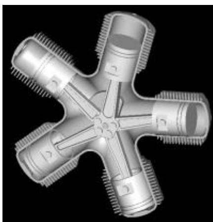
Radial_engine.gif pour un moteur en étoile
