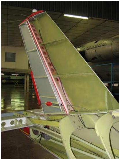
Structure d'un empennage.
