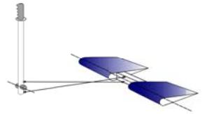
Avec des bielles on peut actionner des servocommandes hydrauliques.
