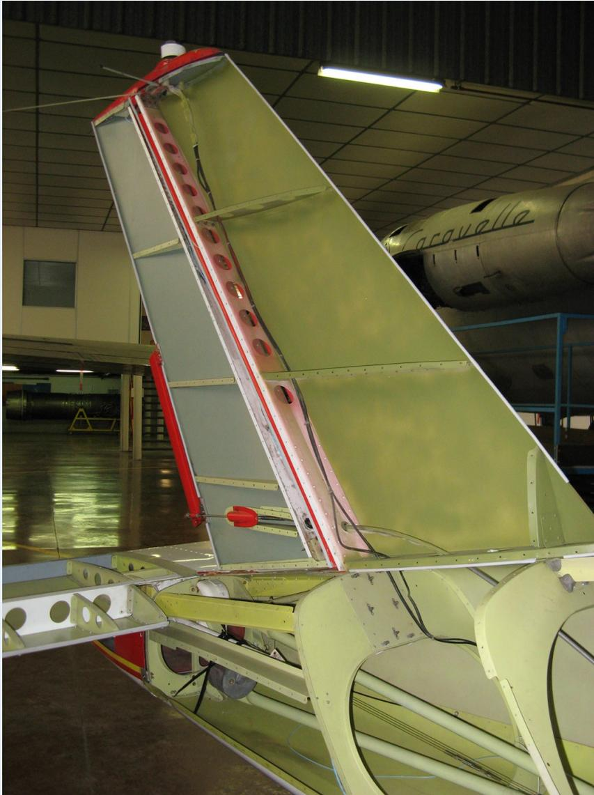
Structure d'un empennage.
