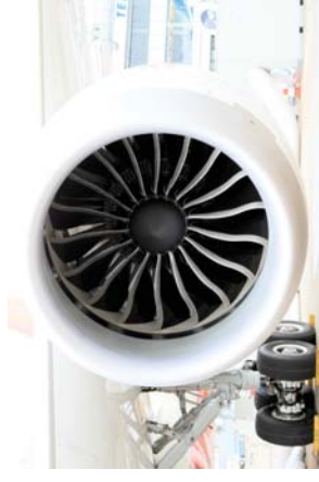
Entrée d'air et Fan B787
