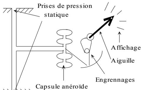
une deuxième bielle qui met en rotation un râteau. Un système d'engrenage permet de faire tourner une aiguille sur un cadran gradué .....
