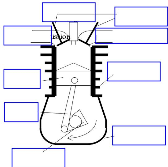
soupapes reliées aux pipes d'admission pour faire entrer le mélange air-carburant et aux pipes d'échappement pour évacuer les gaz brûlés.
