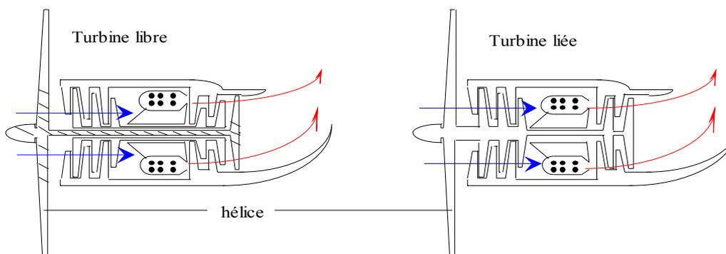
Pour pallier le manque de puissance des moteurs à piston et à la grande consommation en carburant des réacteurs, des ingénieurs ont développé un concept hybride : le turbopropulseur.
