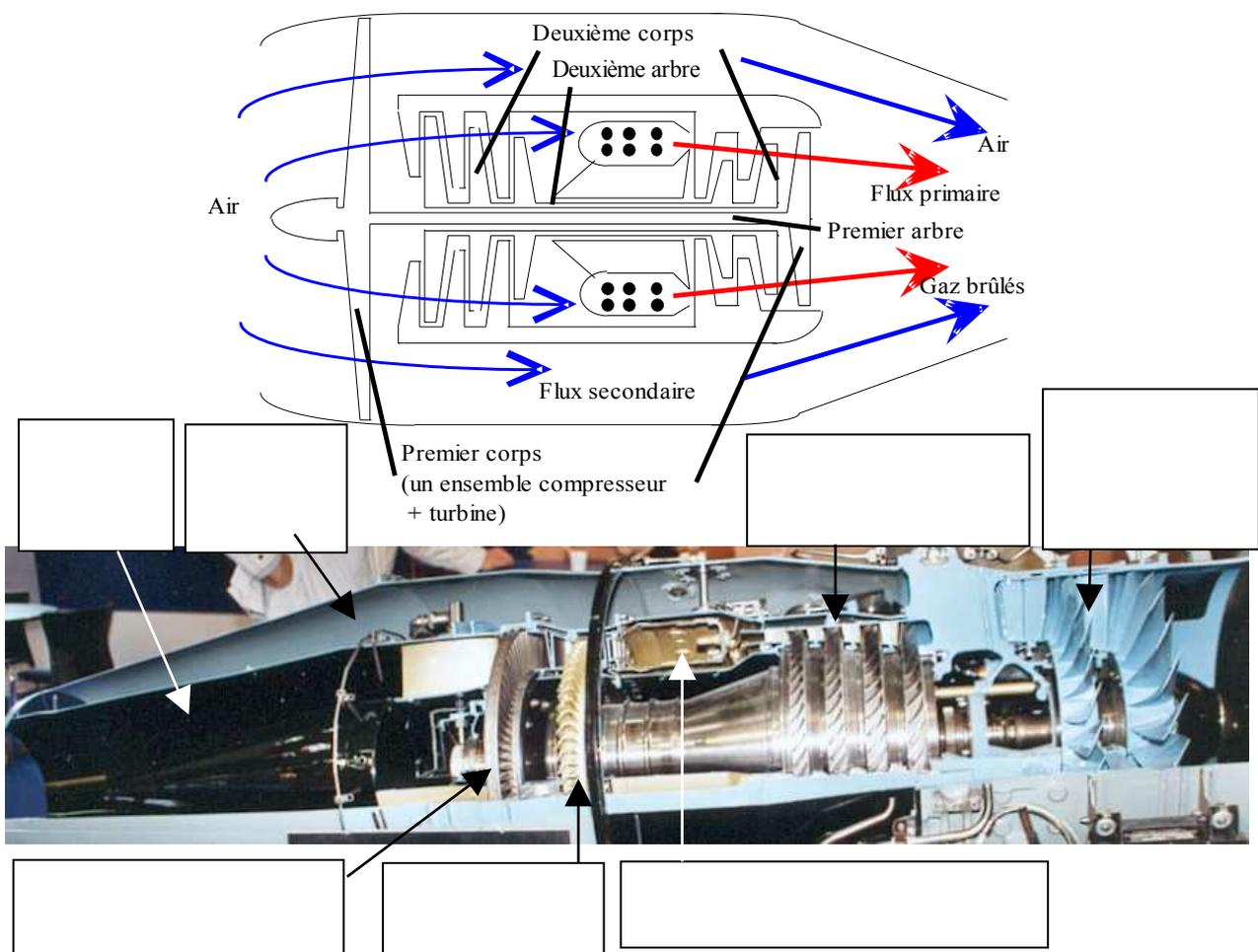
La photographie ci-dessus représente le LARZAC 04, réacteur de l'alphajet. C'est un réacteur double corps double flux. Le flux froid est moins important que le flux chaud (taux de dilution  $\approx 0,3$ ).
