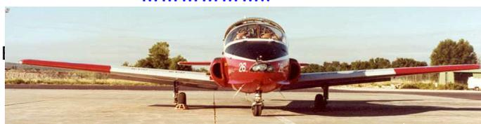
Les ailes peuvent également être disposées différemment par rapport au fuselage. Elles peuvent être en position haute, médiane ou basse :
