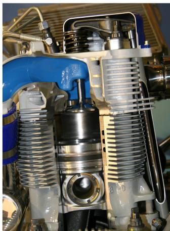
permet de transmettre le mouvement du piston à l'arbre moteur, mais aussi de faire remonter le piston dans le cylindre pour comprimer les gaz avant la combustion. Le carter en bas du moteur contient l'huile qui assure la lubrification des parties mobiles. La tête du cylindre comprend des
