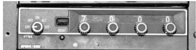
A bord de l'appareil, l'IFF se présente comme un boîtier avec 4 chiffres affichés et une molette de réglage par chiffre. Un interrupteur permet de le mettre en route. Il possède également un bouton de test. Son bon fonctionnement est obligatoire pour pouvoir voler dans des espaces aériens contrôlés.
