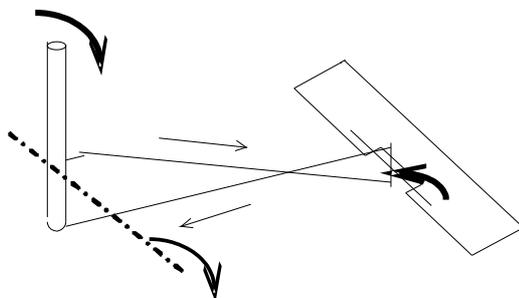
Le plus ancien consiste à transmettre le mouvement du manche vers les commandes par l'intermédiaire ..... et de poulies. Les câbles de la profondeur permettent de faire bouger les surfaces mobiles de l'empennage de façon .....
