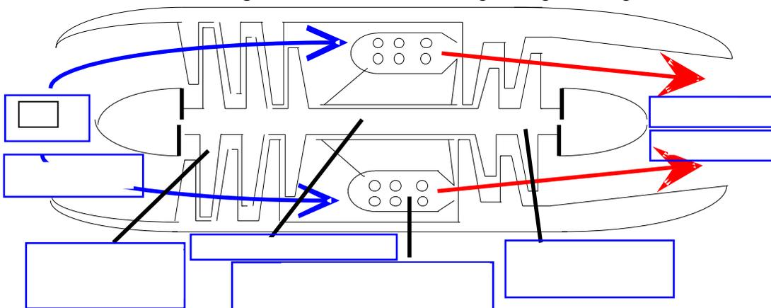
Dans un turboréacteur, on admet de l'air par une **entrée d'air** pour le guider jusqu'à l'entrée du moteur proprement dit.
