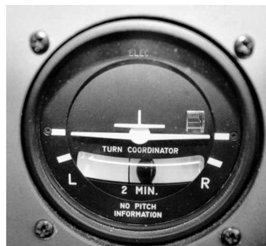
tourne, le gyroscope garde son orientation dans l'espace. Dans ce type d'instrument la rotation du gyroscope est assurée par un moteur électrique ou par entraînement pneumatique.
