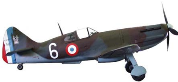
Dewoitine D250 P = 935CV Vmax = 540km/h Plafond = 11000m Charge utile = 580kg
