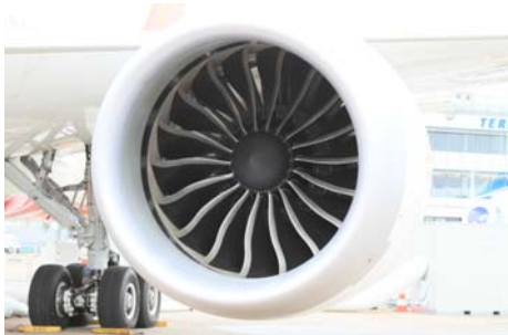
Entrée d'air et Fan B787
