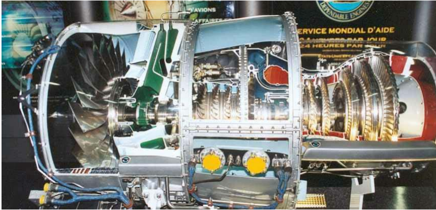
Réacteurs double corps – double flux : civil de chez PW et militaire (LARZAC – a jet).
