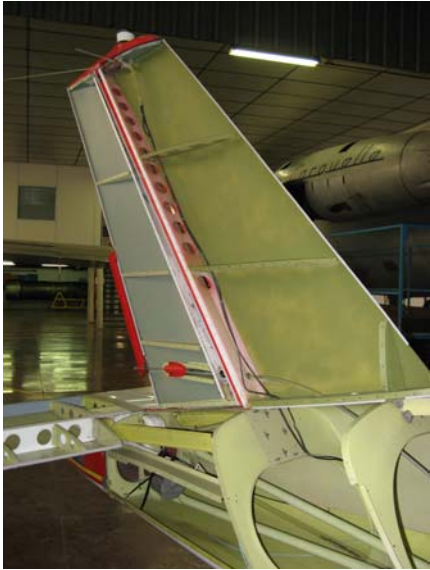
Structure d'un empennage.
