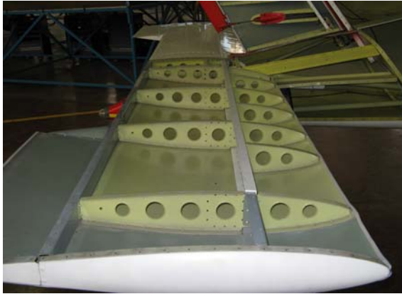
Structure d'un empennage.
