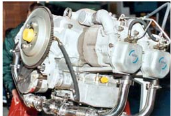
4 cylindres à plat diesel - 7 cylindres rotatifs en étoile
