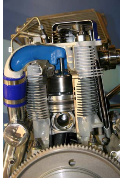
Ecorché d'un cylindre. 12 cylindres en V
