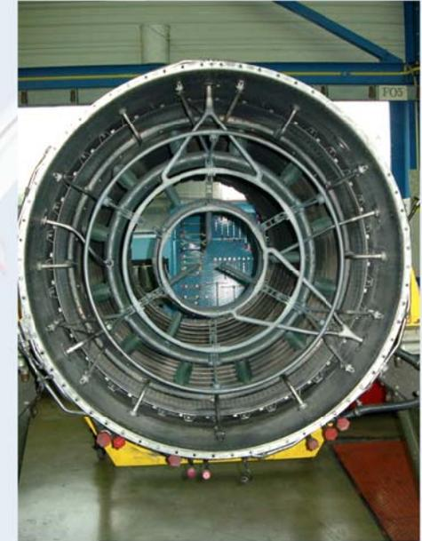
Paupières de tuyères d'un Typhoon (contrôle de la géométrie en sortie de tuyère) et dispositif de poussée vectoriel et contrôle des paupières pour le même appareil.
