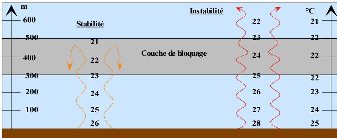
Si le gradient de température de l'atmosphère est le même que celui de l'air sec, la bulle qui s'est échauffée sur le sol part avec une température supérieure à celle de l'air ambiant et se refroidit avec le même gradient (1 °C / 100 m). Sa température reste donc supérieure à celle de l'atmosphère et l'ascension se poursuit.
