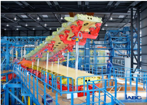
Test de flexion du caisson central d'une aile d'A380, ça semble énorme ! Attention superposition d'images regroupant la position normale et contrainte !
