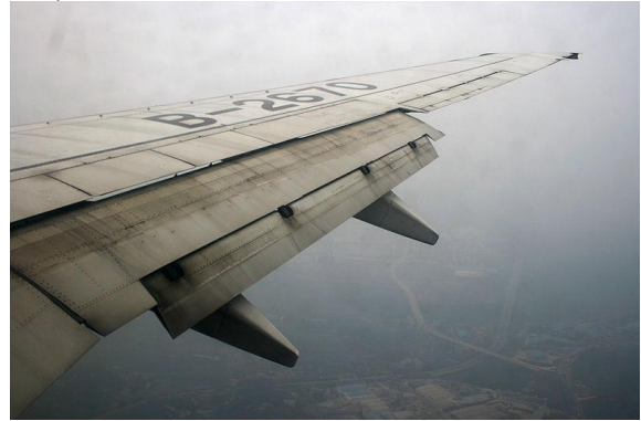
Volets fowlers 3 sections (avec fentes)
