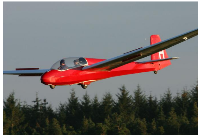
Planeur ancien : K 13 ↑ (aérofreins d'extrados ET d'intrados)
