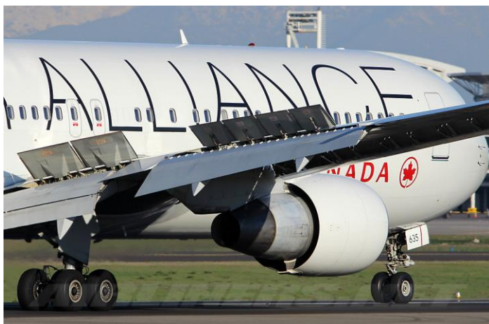
Boeing 767 Spoilers ouverts ⤴ et schéma de contrôle ⤵
