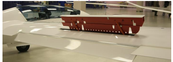
Planeur ancien : K 13 ↑ (aérofreins d'extrados ET d'intrados)
