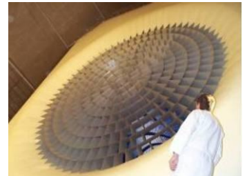
Grille (ou filtre) réalisant un écoulement laminaire.
