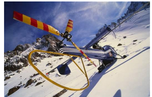
Rotor anti-couple classique (Alouette III)
