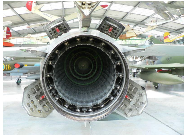
Mig 23 : quatre panneaux d'aérofreins déployés autour de la tuyère.
