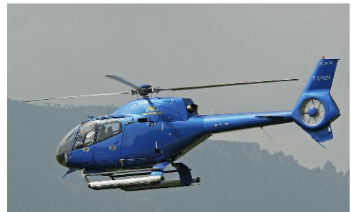
Un modèle Eurocopter avec un anti-couple dans un "Fenestron"
