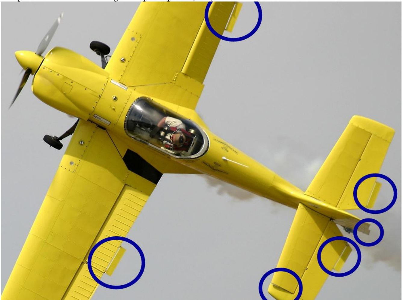
Des compensateurs et trim sur toutes les gouvernes de cet avion d'acrobatie. Notez aussi, tout en bas à droite, la partie déportée dite "à corne débordante" qui permet de réduire les efforts du pilote lorsqu'il actionne la gouverne de profondeur.
