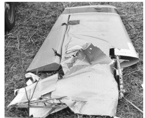
Aile d'un SkyHooper détachée en vol probablement par dépassement des contraintes autorisées.
