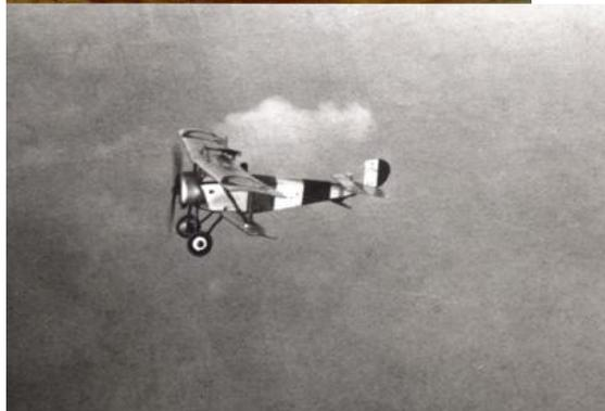
*⇧ Nieuport XI mitrailleuse au-dessus de l'aile.*
