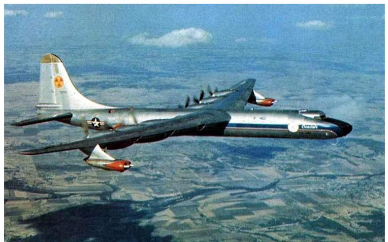
*Cet avion avait un nez totalement remodelé conçu pour faciliter l'installation de la capsule spéciale de 12 tonnes de protection de l'équipage. Tout l'avion était modifié et offrait même la possibilité de retirer le réacteur nucléaire après chaque vol pour des examens détaillés et d'éventuel essai au sol supplémentaire.*
