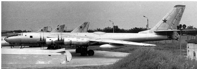
Ce laboratoire volant fut baptisé **Tu-95 LAL** (Letaiouchaïa Atomiaïa Laboratoriïa "laboratoire atomique volant") ou Tu-119. L'avion fut équipé de deux types de moteurs. Des NK42MV normaux et deux NK44A expérimentaux, fonctionnant grâce à un réacteur nucléaire. Ce dernier fut installé dans le fuselage, tout de suite derrière le centre de gravité.
