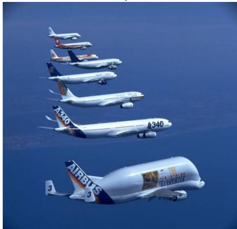
Il a su comprendre les besoins des exploitants en produisant une série d'avions adaptée à chaque contrainte : de l'**Airbus 319** (biréacteur à faible capacité) jusqu'à l'**Airbus 340** (quadriréacteur capable d'effectuer la moitié du tour du monde sans escale).
