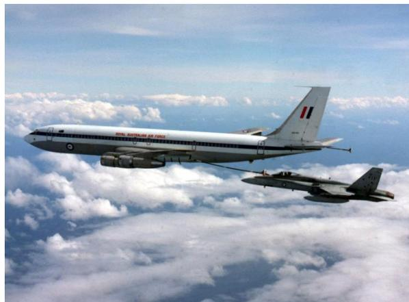
*Boeing-707 utilisé en ravitaillement (KC 135) ⚡*
