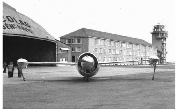
A 300 km/h, vitesse nécessaire pour comprimer l'air, le pilote injecte du carburant dans cet air comprimé, ce qui produit une forte détente et une forte poussée. L'avion peut alors quitter le quadrimoteur et il devient autonome.
