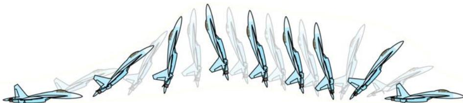
Le "Cobra" ou "Pugachev Cobra" est une manœuvre de combat aérien, plus particulièrement en post-décrochage. Cette manœuvre est rendue possible grâce à une combinaison du contrôle du tangage, de stabilité, et d'efficacité des moteurs et des entrées d'air à angle d'attaque très élevé. Utile en combat aérien, le "Pugachev Cobra" effectué rapidement permet des virages serrés et peut ainsi désarçonner l'adversaire, l'empêchant ainsi de verrouiller sa cible ou encore de
